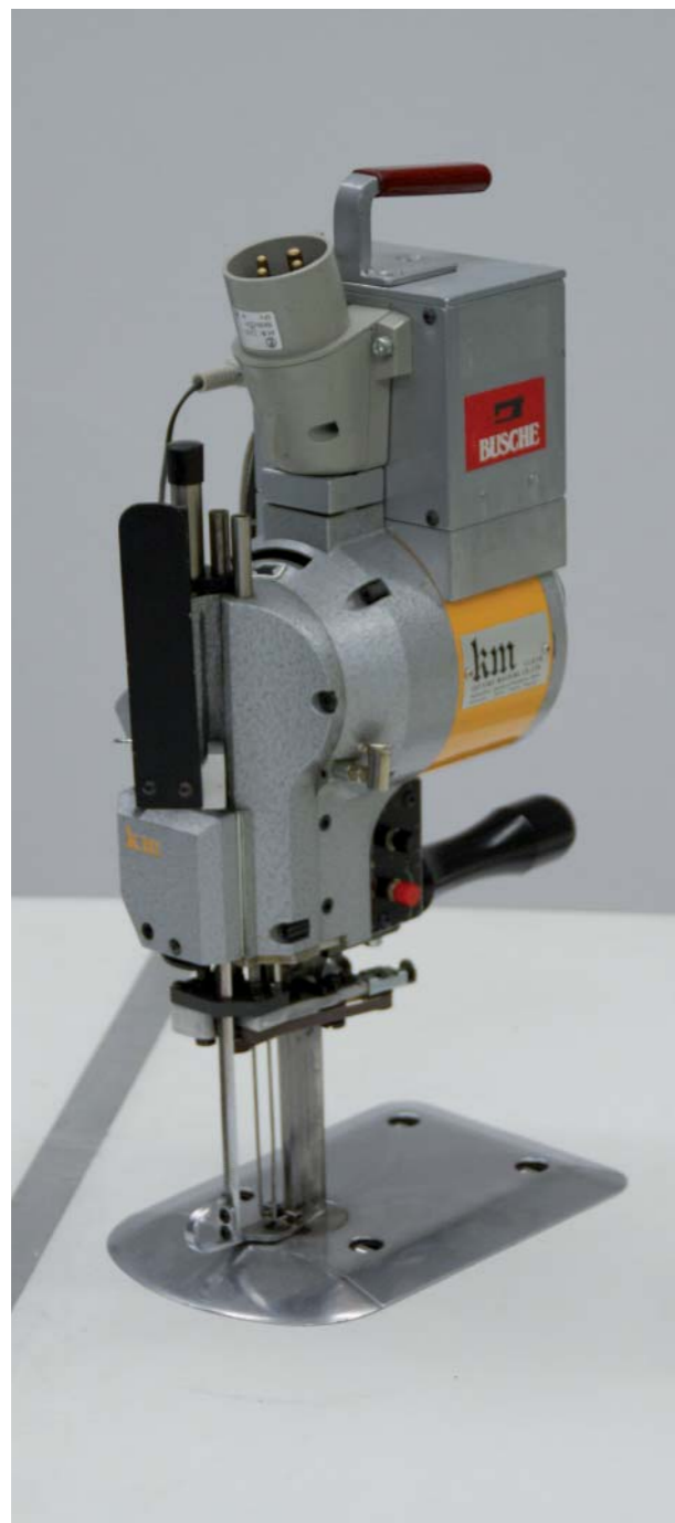
Geeignet zum exakten Zuschneiden von Stoffen aller Art: das Stoßmesser.
