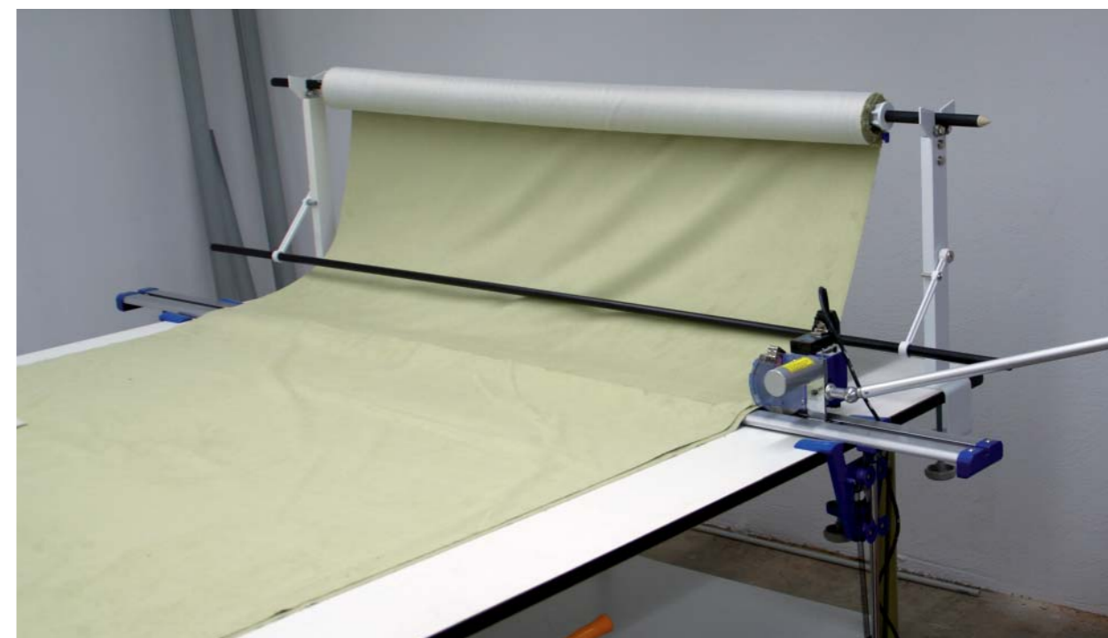
Auf dem Legetisch der Näherei können Stoffe bis zwei Meter Breite ausgelegt werden.
